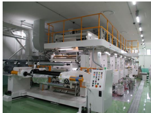
アルミ用5色グラビア輪転印刷機
