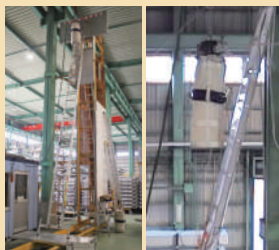
Photo:落下試験 (3REN-9.0A+トド丸セット)
