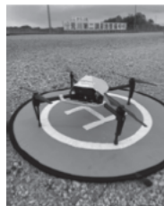
画像2 ドローンによる測量盛土管理
