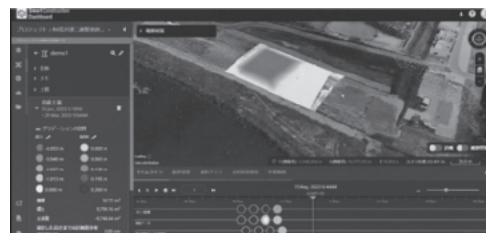
画像2 ドローンによる測量盛土管理
