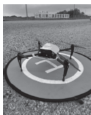
画像2 ドローンによる測量盛土管理
